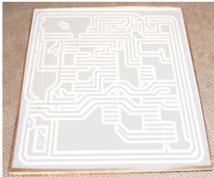
Ilustración 25 - Transferencia del diseño de la tarjeta de circuito impreso a la placa fenólica
