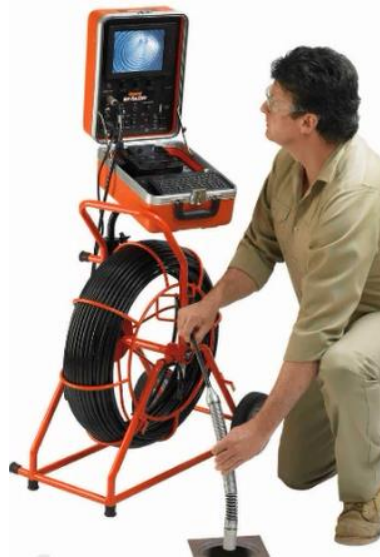
Figura 3.13. Inspección de la tubería con una cámara de video
