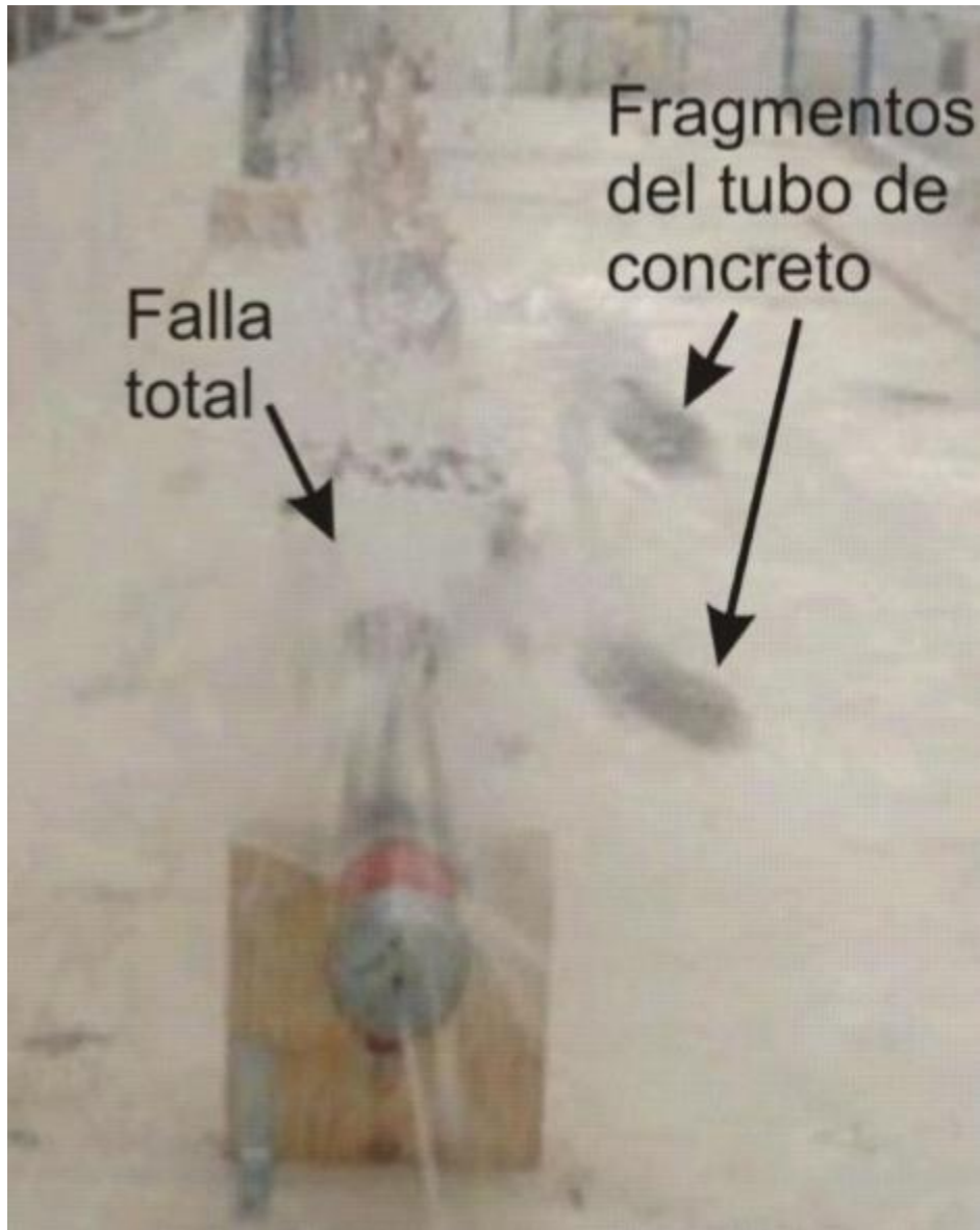
Figura 4.13. Lanzamiento por los aires de fragmentos de tubo al momento de la falla
