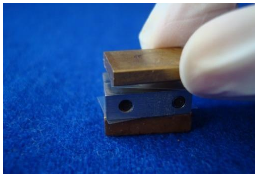
Figura 5. Colocando la placa sobre el molde ejerciendo presión
