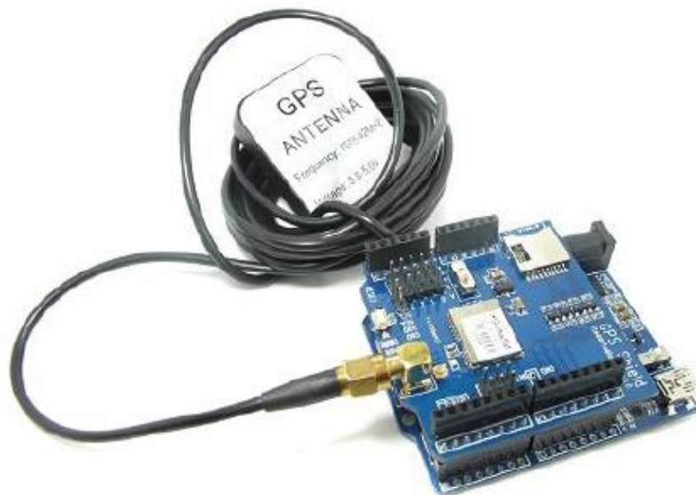
FIGURA 1.11 ITEAD STUDIO GPS SHIELD, ARDUINO UNO Y ANTENA EXTERNA
