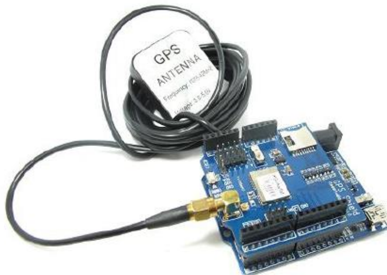
FIGURA 3.10 SHIELD ITEAD STUDIO CON ANTENA GPS EXTERNA CONECTADO A ARDUINO UNO
