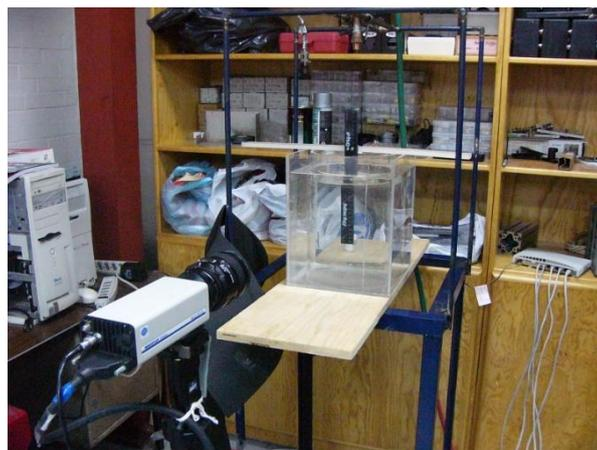
Fig. 2.4. Fotografía del montaje del equipo. Se coloca una cámara ultra rápida a una distancia aproximada de 1 metro con el propósito de visualizar panorámicamente los sucesos fenomenológicos bajo la incidencia de un flujo gaseoso en la superficie libre. Posteriormente se analizan las imágenes adquiridas.
