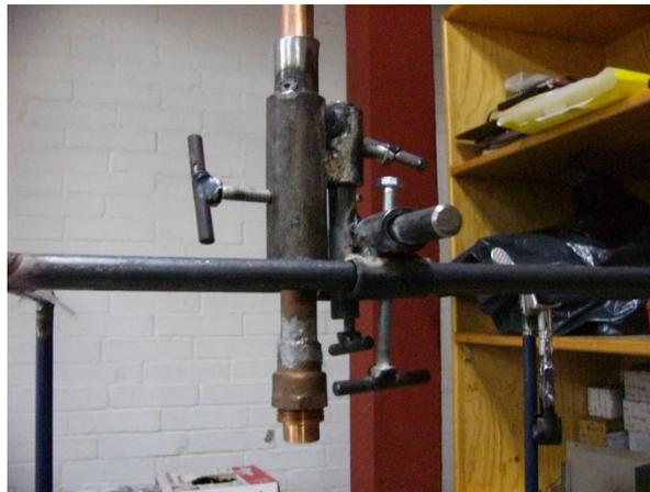
Fig. 2.3. Estructura metálica que permite la variación entre la altura de la tobera y la superficie y el ángulo de la tobera.
