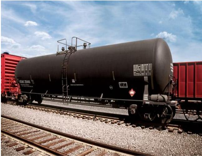
Los carros tanque permiten el transporte de materiales fluidos o gases además son atmosféricos, existen diferentes recubrimientos en su interior como vidrio, acero inoxidable.
