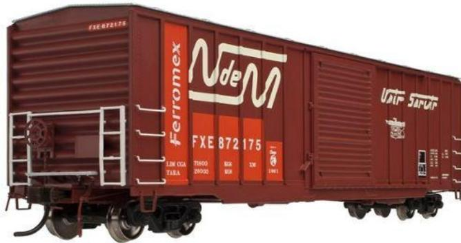
Los furgones es el equipo de arrastre más flexible, se emplean para transportar productos que requieren protección contra la intemperie. Algunas variaciones incluyen amortiguadores para transportar carga frágil como pueden ser obras de arte, componentes electrónicos, o mercancías sensibles a la vibración y movimientos bruscos.
