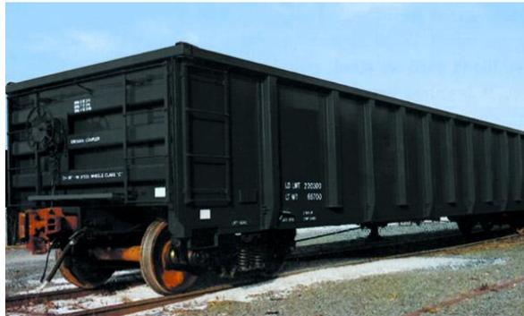
Las góndolas son carros descubiertos que transportan todo tipo de material que no necesita protección contra el medio ambiente, como chatarra, madera elementos estructurales de acero. Estos carros están diseñados para facilitar la carga y descarga por medio de grúas de volteo de carros o magneto.
