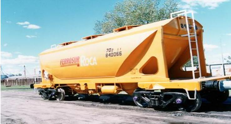
Imagen 82, ejemplo equipo de arrastre tolva cementera, fuente: <http://www.ferrosur.com.mx/servi/flota.html>
