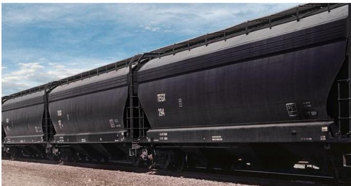
Las tolvas graneleras se utilizan para el transporte de productos industriales que no requieren protección contra el medio ambiente, como el carbón. Posee compuertas en la parte inferior que facilita la descarga de productos a granel.
