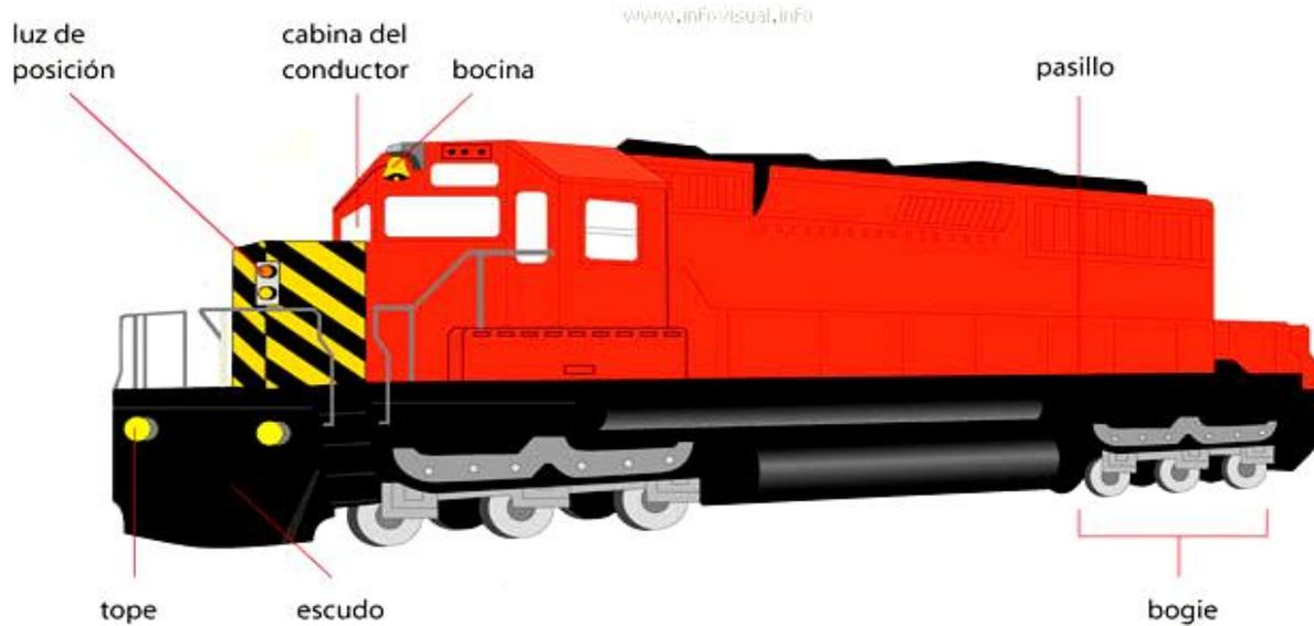
Imagen 99, modelo de locomotora diésel-eléctrica y elementos que la integran, fuente: [temas selectos de ferrocarriles UNAM](#)
