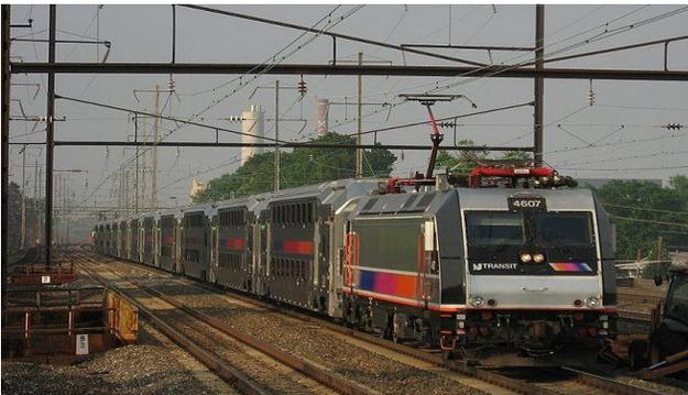
Una ventaja de la electrificación es la ausencia de polución por parte de la locomotora en sí misma. Otras ventajas son mejores prestaciones, menores costos de mantenimiento, y menor costo de la energía eléctrica para las locomotoras
