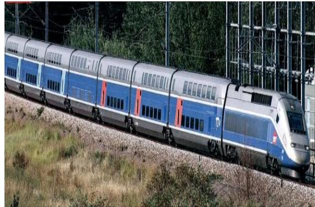
Imagen 118, modelo de tren dúplex, fuente: <http://www.alstom.com/>
