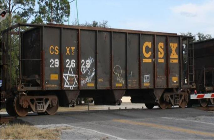
Este tipo de tolvas es similar a la góndola, pero compuertas inferiores o laterales para su carga, se utiliza para transportar carga granel y existen tipos especializados y transporta carbón mineral, piedra, coque, piedra arena, grava.
