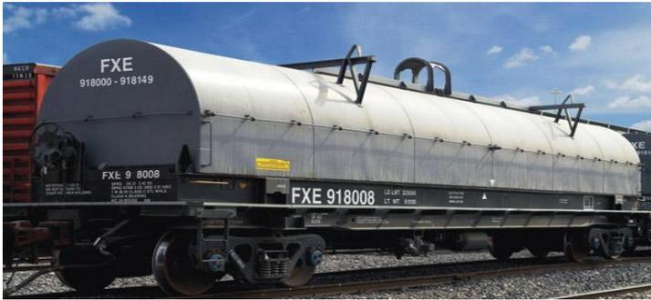
Las góndolas son carros cubiertos que transportan todo tipo de material que necesita protección contra el medio ambiente. Como lo son bobinas de lámina, rollos de lámina, placas de acero.
