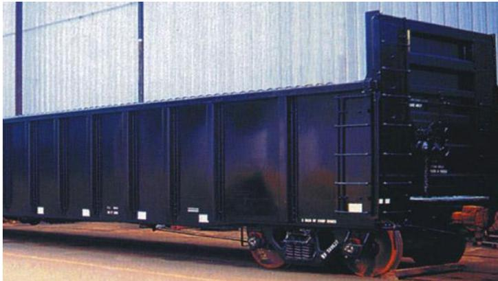
Las góndolas son carros descubiertos que transportan todo tipo de material que no necesita protección contra el medio ambiente. Estos carros están diseñados para facilitar la carga y descarga por medio de grúas de volteo de carros o magneto.
