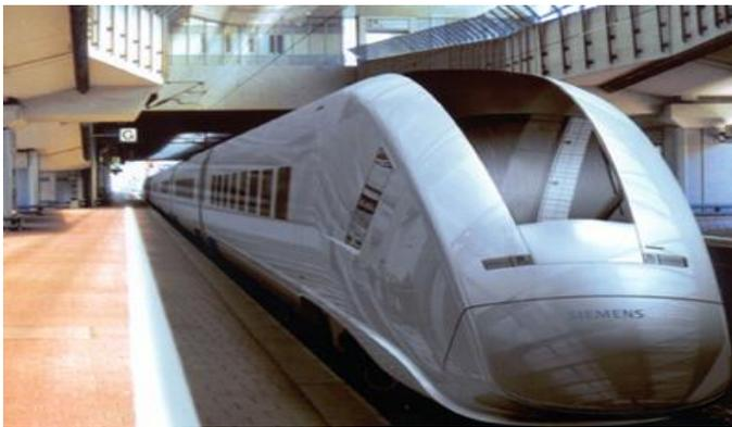
**5.13.2 VENTURIO:** Está destinado a mayores velocidades entre 160 km/h y 250 km/h, tren longitudes de 3-9 (originalmente 3-12) coches y activa opcional de inclinación. El diseño permite la instalación de varios tipos de tracción equipos, es de diésel-eléctrico.
