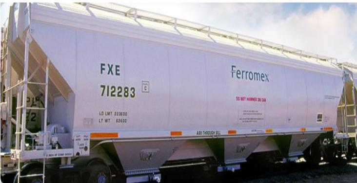
Las tolvas graneleras se utilizan para el transporte de productos agroindustriales que requieren protección contra el medio ambiente, como café, o maíz o trigo. Poseen compuertas en la parte superior e inferior que facilitan la carga y descarga de productos a granel.
