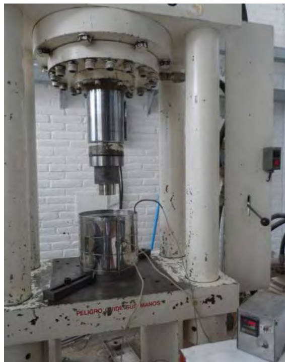
Figura 2.21 Calentamiento del dado de extrusión por medio de una resistencia.
