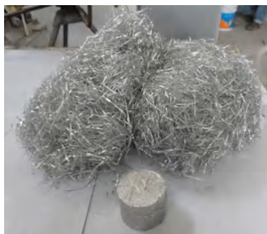
Figura 2.20 Primer tocho compactado junto con la cinta restante.
