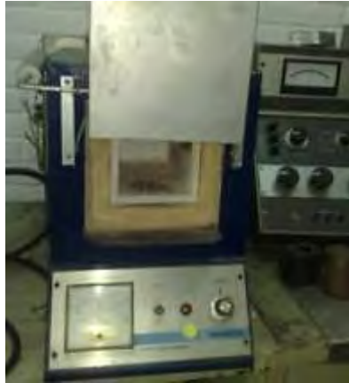
Figura 2.16 Mufla para tratamiento térmico (IIM-UNAM).
