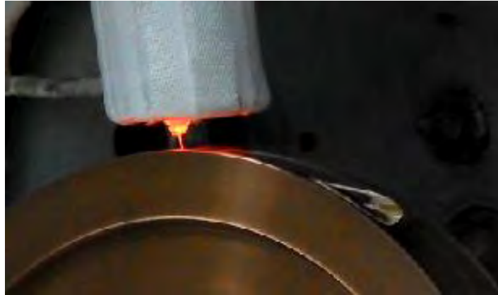
Figura 2.6 Momento de la inyección del metal fundido.
