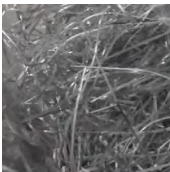
Figura 3.3 Cintas obtenidas de la técnica melt spinning .
