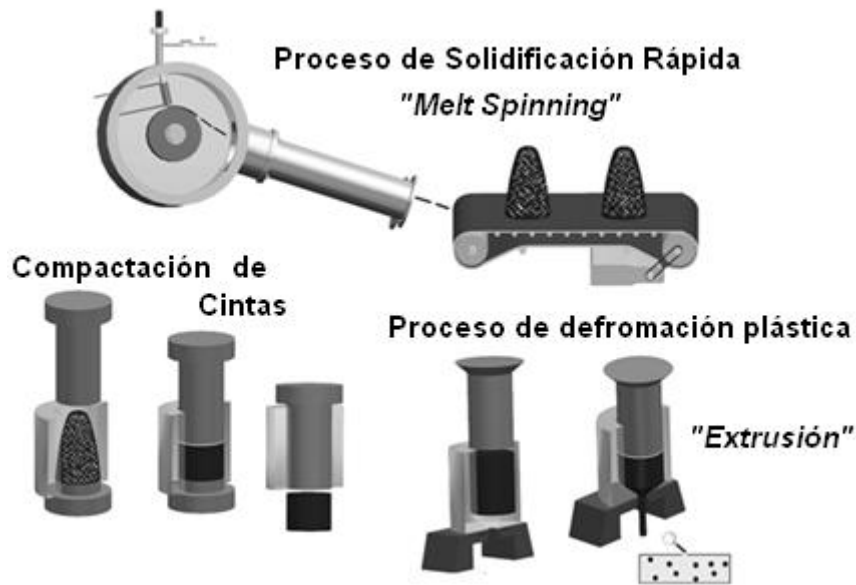
Figura II. Combinación de Melt Spinning y Extrusión.
