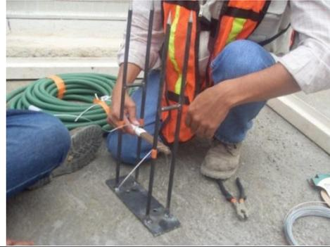
Deformímetro colocado en soporte, listo para ser instalado.
