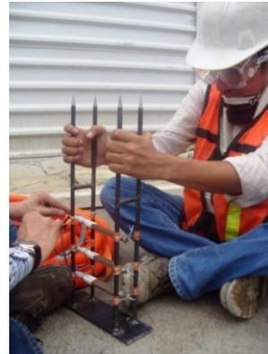
Deformímetros SGV-4A, SGV-4B y SGV-4C colocados en el soporte, listos para ser instalados.
