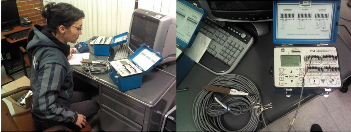
**Figura 29. Toma de lecturas iniciales de deformímetros de un cuarto de puente**
