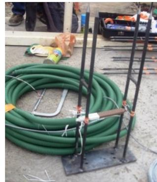
Fijación en el soporte de los deformímetros SGV-4A, SGV-4B y SGV-4C (ver Figura 30) que fueron instalados en la clave del túnel con el fin de conocer la deformación en diferentes posiciones dentro del revestimiento.
