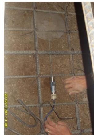
Posición final del deformímetro eléctrico SGV-10 y celda de presión de cuerda vibrante CPVW-1 en el espacio correspondiente a la zapata izquierda.
