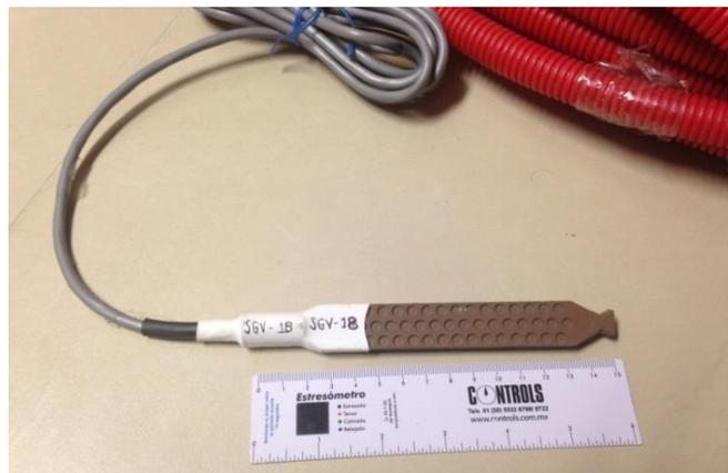
Figura 18. Deformímetro eléctrico de un cuarto de puente
