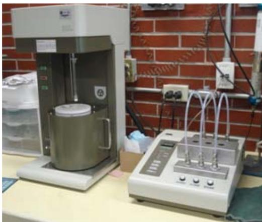
*Figura 16. Equipo Belsorp II mini, Bel Japan, Inc. (izquierda) y equipo Belprep II vac, Bel Japan, Inc. (derecha)*
