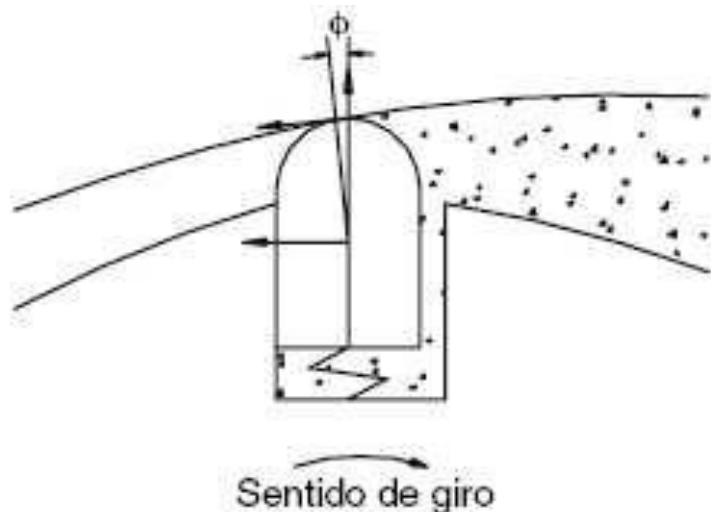
Fig. 45.- Funcionamiento del segmento periférico.
