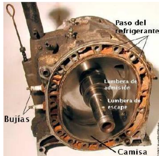
Fig. 60.- Sistema de refrigeración por agua con flujo axial. Motor con lumbreras en el estator lateral.
