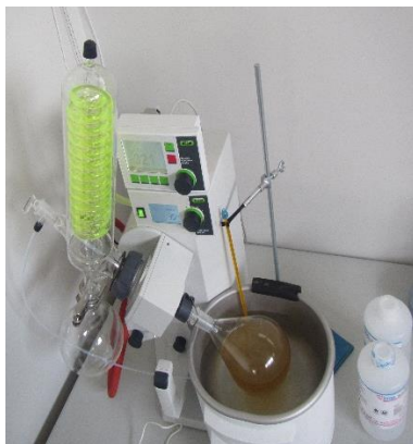
Figura 2.14 Rotavapor Buchi R-215 automatizado
