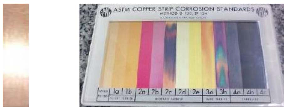
Figura 3.16 Tira de cobre y tablilla con el rango de clases de corrosión de tiras cobre
