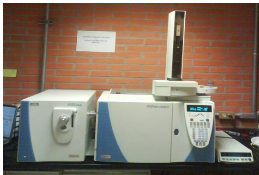
Figuras 2.8 Cromatógrafo de gases acoplado a un detector de espectrometría de masas
