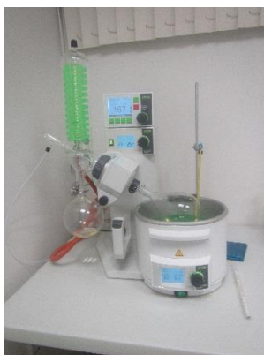
Figuras 3.9 y 3.10 Rotavapor Buchi R -215 donde se obtuvo el bioqueroseno
