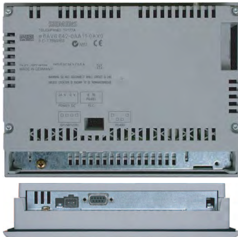
Figura 4.4.2 Vista trasera e inferior de la pantalla TP177A.
