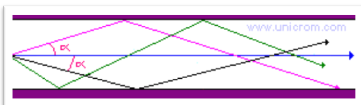
Figura 2.2.7. La imagen muestra como viajan los rayos ópticos reflejados, alcanzando a recorrer diferentes distancias.
