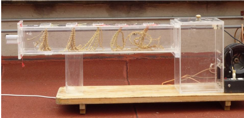
Figura 1. Mini túnel de viento con espigas de maíz construido en el taller mecánico del Centro de Ciencias de la Atmósfera de la UNAM
