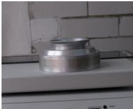
Figura 3. Tambor interno de la trampa Hirst de granos de polen
