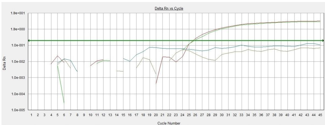
Figura 24. La línea roja y la verde corresponden al material de referencia. No se detectó el evento MON89034. El umbral corresponde a 0.2
