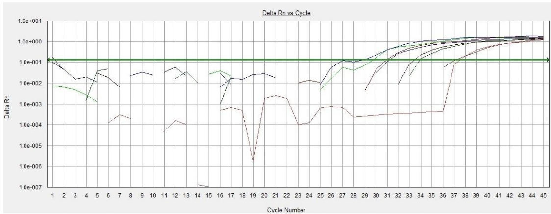
Figura 19. qPCR de la mezcla de reacción que contenía 40 ng de albúmina. La pendiente que se obtuvo fue de -3.89, r2 igual a 0.989614 y el umbral de 0.1393
