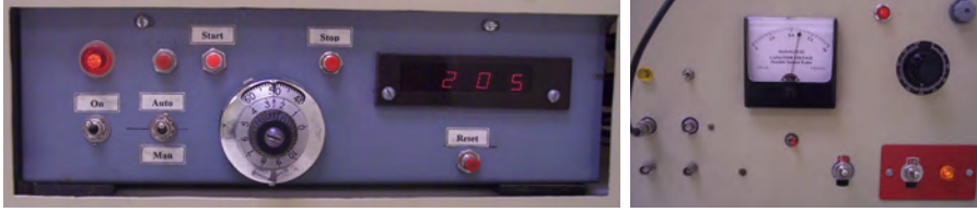
Figura 4-4: Tablero de control del GMOCH. Izquierda Unidad generadora de pulsos con retardo. En la imagen puede verse, de izquierda a derecha, el interruptor de encendido, el selector modo automático/manual, el botón de inicio, el botón de paro, el dial selector del tiempo de retardo, el display 4D/7 segmentos que muestra el número de ondas emitidas, el botón de reinicio. Derecha De izquierda a derecha: salidas de osciloscopio (Osc1, Osc2), voltímetro de alto voltaje, selector del voltímetro (C1,C2), interruptor del alto voltaje, control del alto voltaje (variación), interruptor general.
