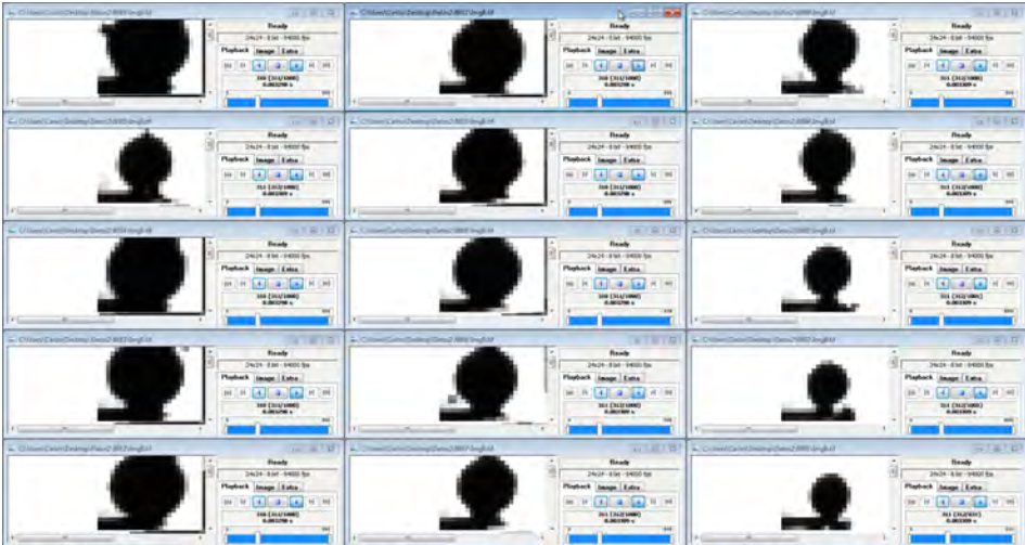
Figura 4-13: Mosaico de las grabaciones variando el voltaje de excitación de los cristales piezoeléctricos. Se observa una respuesta muy pobre o nula a voltajes inferiores a 4 KV y una respuesta exagerada, que no alcanza a ser tomada en la región de captura, por encima de este voltaje.
