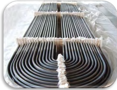
Figura 2.4 Tubos para intercambiador de acero inoxidable en forma de U
