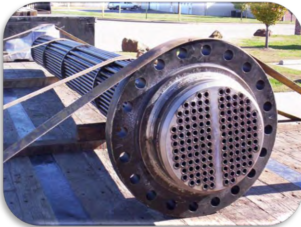
Figura 2.13 Banco de tubos con arreglo cuadrado
