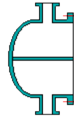
Figura 2.45 Cabezal frontal de cubierta integrada o Bonnet (tipo B)
