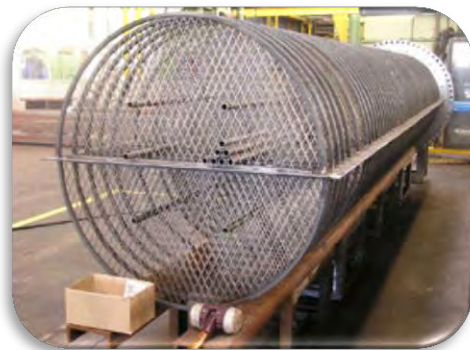
Figura 2.26 Vista completa de deflectores de varilla de intercambiador de calor
