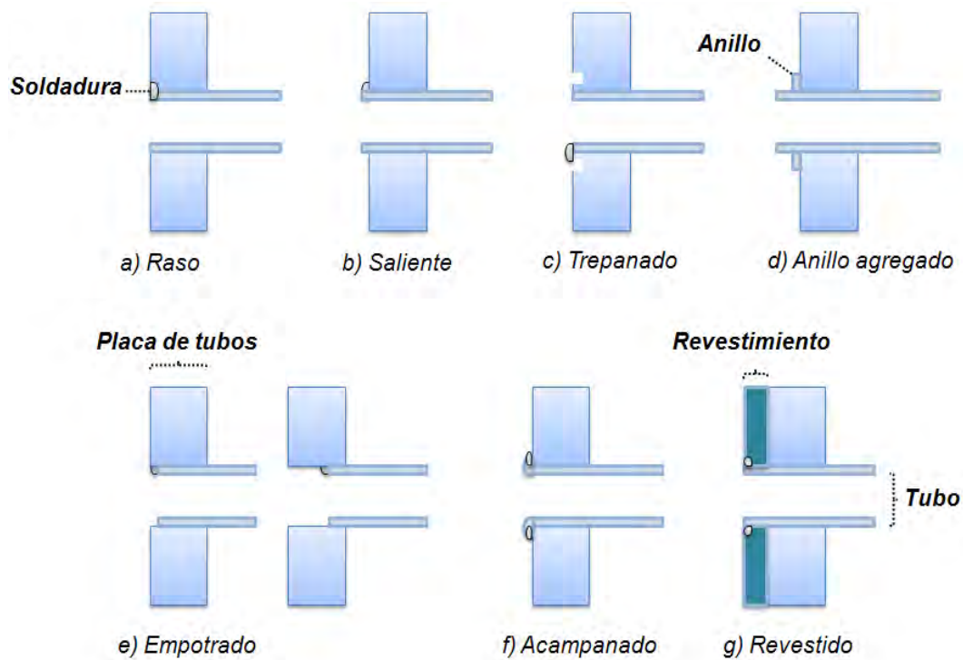
Figura 2.33 Técnicas para lograr buen sellado por medio de soldadura
