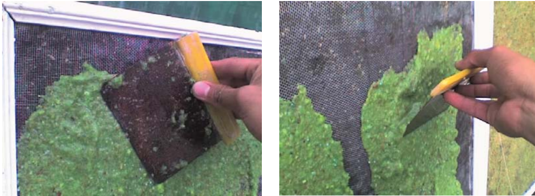
Figura 29. Aplicación en vertical de la hidrosiembra experimental con ayuda de una espátula.
