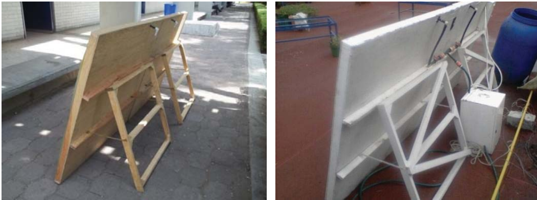
Figura 21. (a) Pánenes verticales con un ángulo de 76^\circ . (b) Vista posterior de ambos pánenes terminados.
