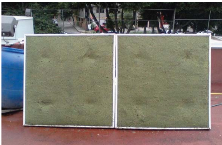
Figura 30. Páneles verticales hidrosebrados.
