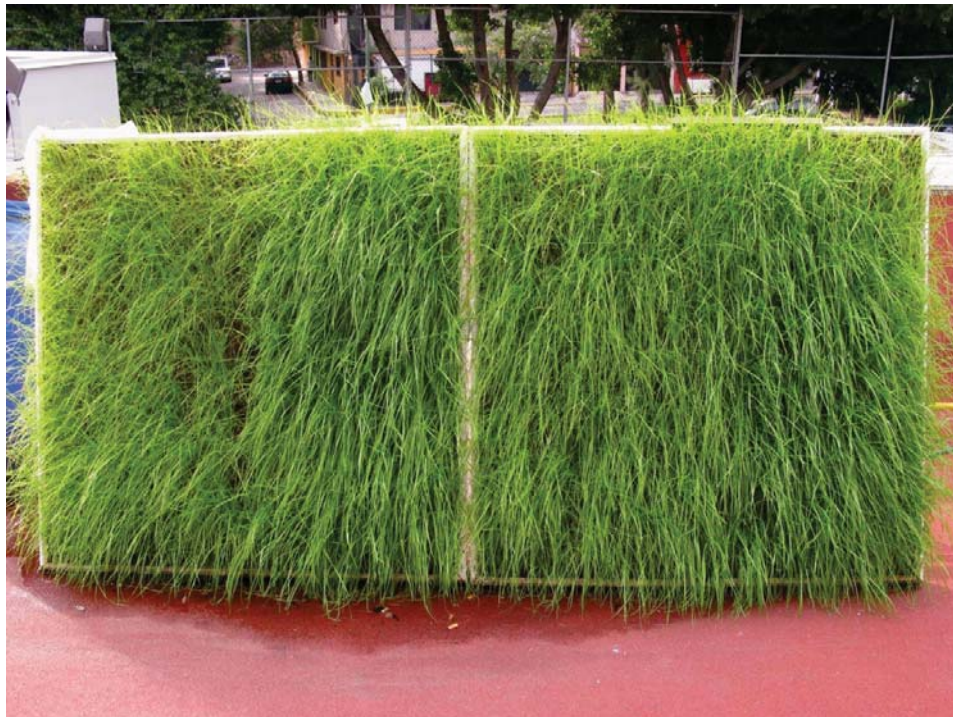
Figura 36. Páneles verticales a un mes después del hidrosembado con la malla sombra retirada.
