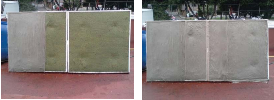
Figura 31. Colocación de la tela de yute a ambos paneles, previamente hidrosembados.
