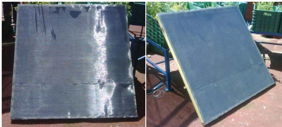
Figura 27. Páneles verticales con la malla de contención clavada al marco de los bastidores.
