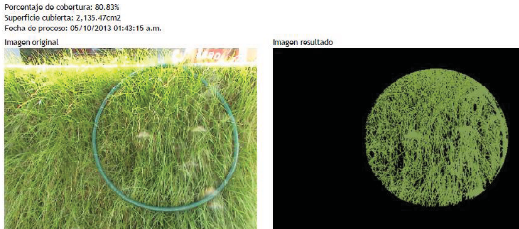
Figura 44. Imagen muestra del resultado de porcentaje de cobertura con el programa CobCal v1.0. Se obtiene el porcentaje de cobertura, la superficie cubierta, la fecha y hora de procesamiento.
