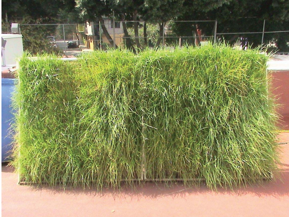
Figura 37. Páneles verticales a dos meses después del hidrosembado.
