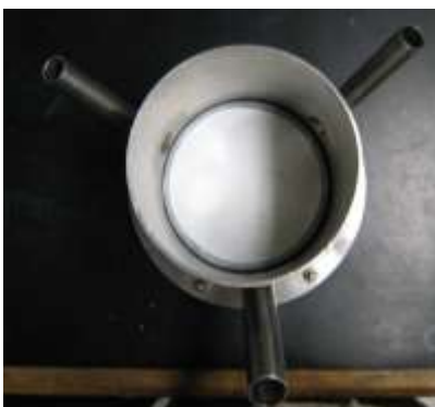
Figura 24. Sistema experimental a nivel laboratorio con reactor tipo balsa.
