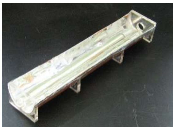
Figura 28. Perfil con curvatura de parábola compuesta con soportes de acrílico.
