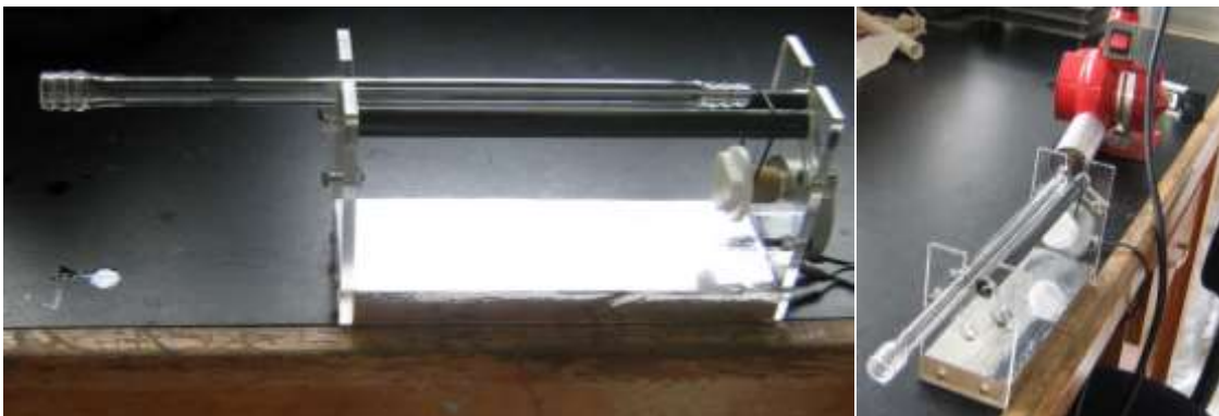
Figura 30. Dispositivo rotatorio construido para el recubrimiento de los tubos de vidrio.
