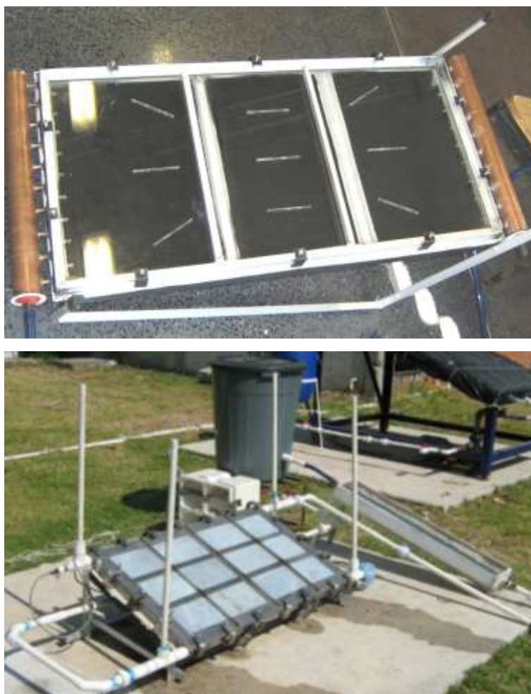
Figura 23. Reactores fotocatalíticos basados en un colector plano. Arriba, primera versión con cabezales de cobre de 1 in. Abajo, versión final en acero inoxidable tipo A-304.
