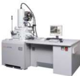
Figura 17. Microscopio electrónico de barrido JEOL Modelo JSM-5900LV.
