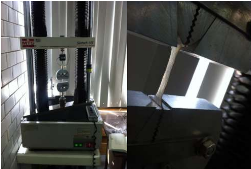
Figura 15. Pruebas de módulo de elasticidad. Maquina Universal de tracción Sintech. Modelo MTS
