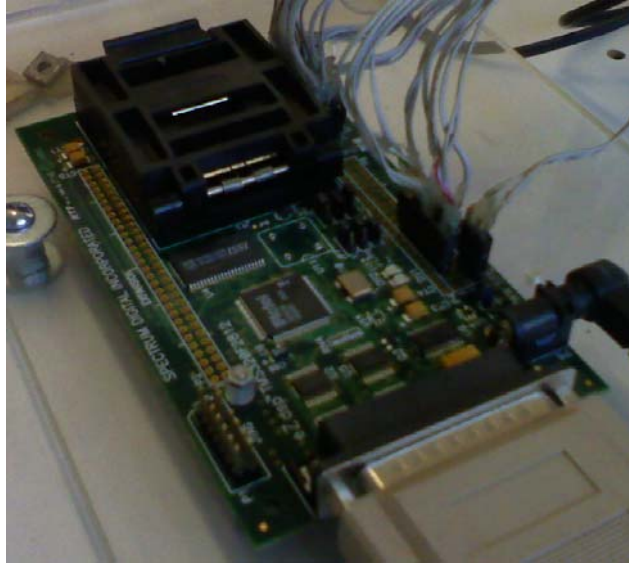
Figura 4.7. Tarjeta de desarrollo DSK TMS320F2812 del cual se obtienen las señales.
