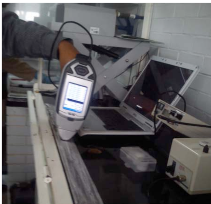
Figura 4.2. Medición de los núcleos sedimentarios a través del equipo de Fluorescencia de rayos X Niton XL3t.
