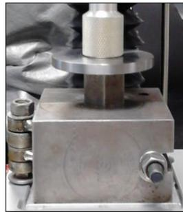
*Figura 15.* Compactación del polvo con matriz y punzón adaptados para el texturómetro.
