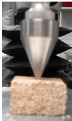
*Figura 13.* Prueba de dureza por penetración.
