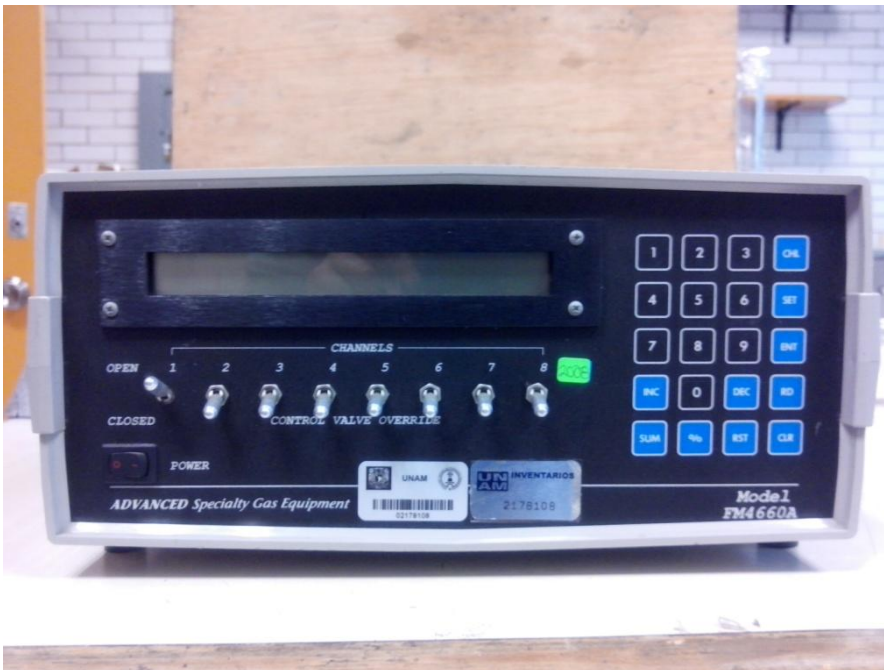
Figura 18. Consola para regular los controladores de flujo másico.
