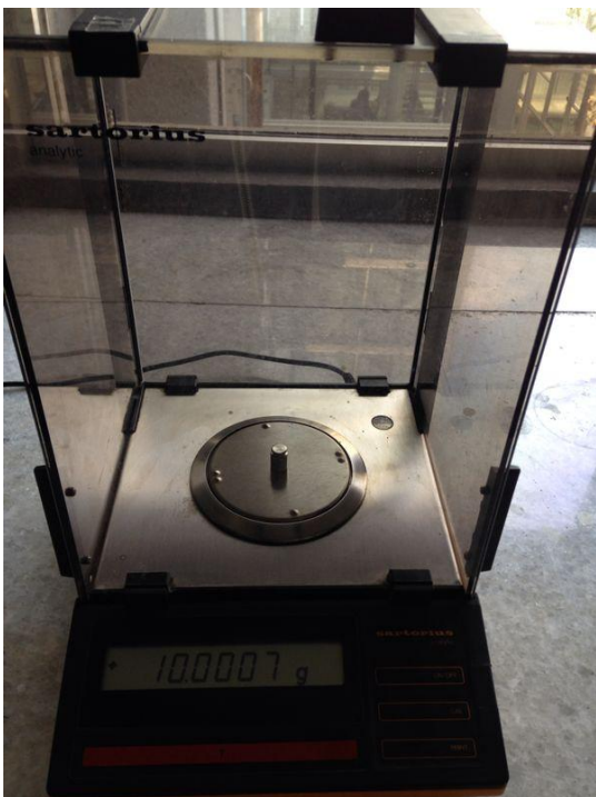
Figura 28. Determinación de masas de 1 g a 10 g.
