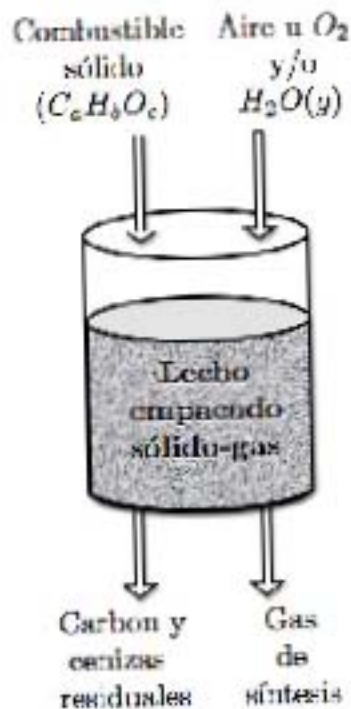
Figura 2.1: Gasificador tubular de lecho empacado de flujos descendentes.
