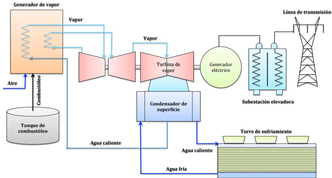
Figura 3.3. Esquema de una planta termoeléctrica<sup>18</sup>.
