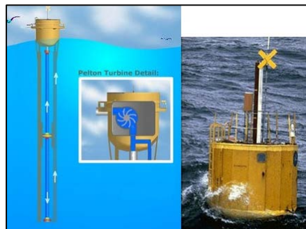
Figura 5.68 Punto absorbedor con turbina Pelton.
