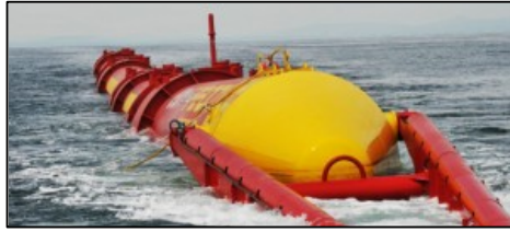
Figura 5.66 Estructura flotante o atenuador
