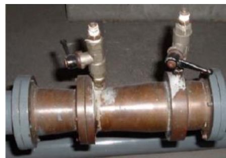
Fig.2.7. Esquema y medidor físico Venturi.
