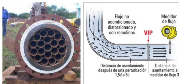
Fig.3.4 Acondicionador de flujo de tubos.
