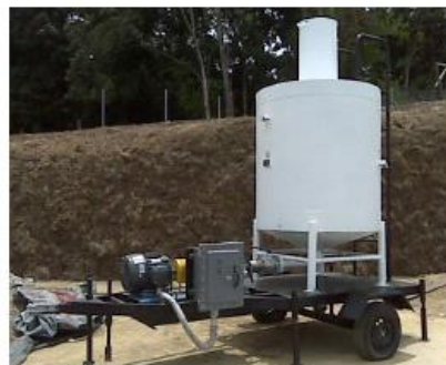
Figura 5.1. Esquema general de la instalación de un medidor de flujo de líquidos cuando se emplea para su calibración una medida volumétrica.
