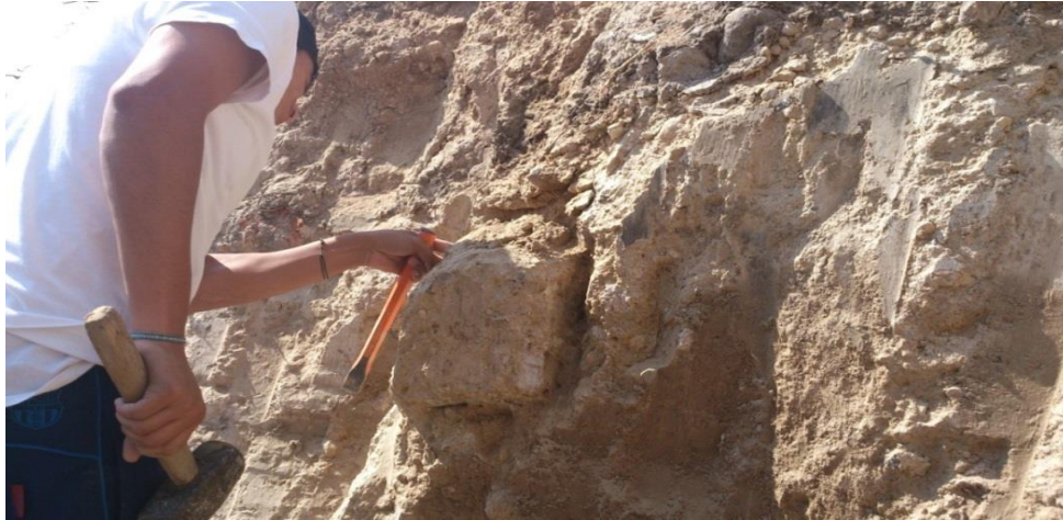
Fig. 1.12 Labrado de muestra en campo
