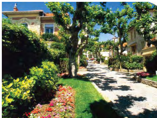
Figura 5.5 – Imagen de calles residenciales en desarrollos europeos coincidentes en su concepción de diseño y aplicación de principios acordes con los establecidos en los Estados Unidos de América. Adicionalmente puede apreciarse el uso de pavimentos adoquinados, la inexistencia de postes de luz, teléfono, cable, etc. Y una arborización y vegetación cuya sombra y humedad impide el calentamiento excesivo de las áreas exteriores en días muy soleados.
