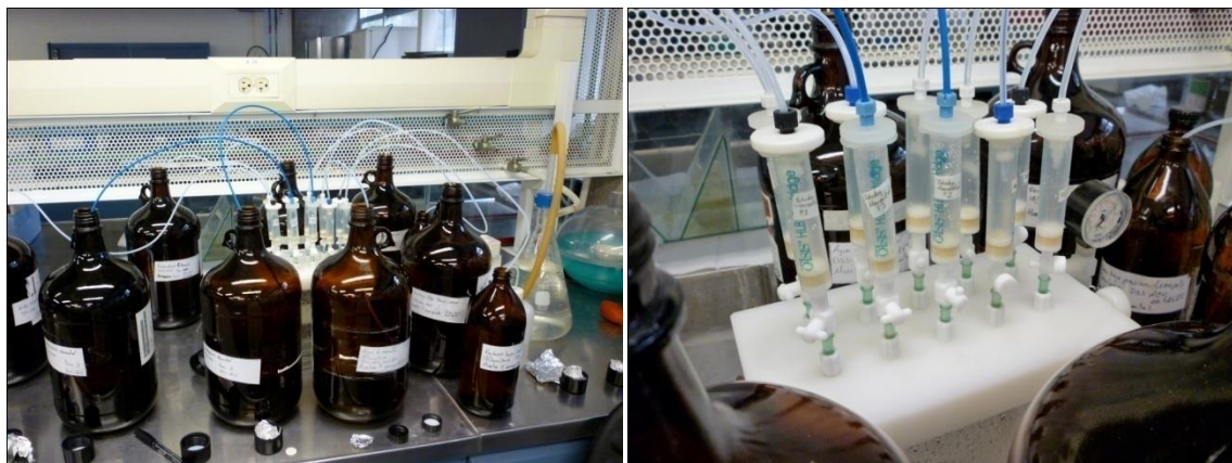
Figura 12. Filtrado por cartuchos Oasis.
