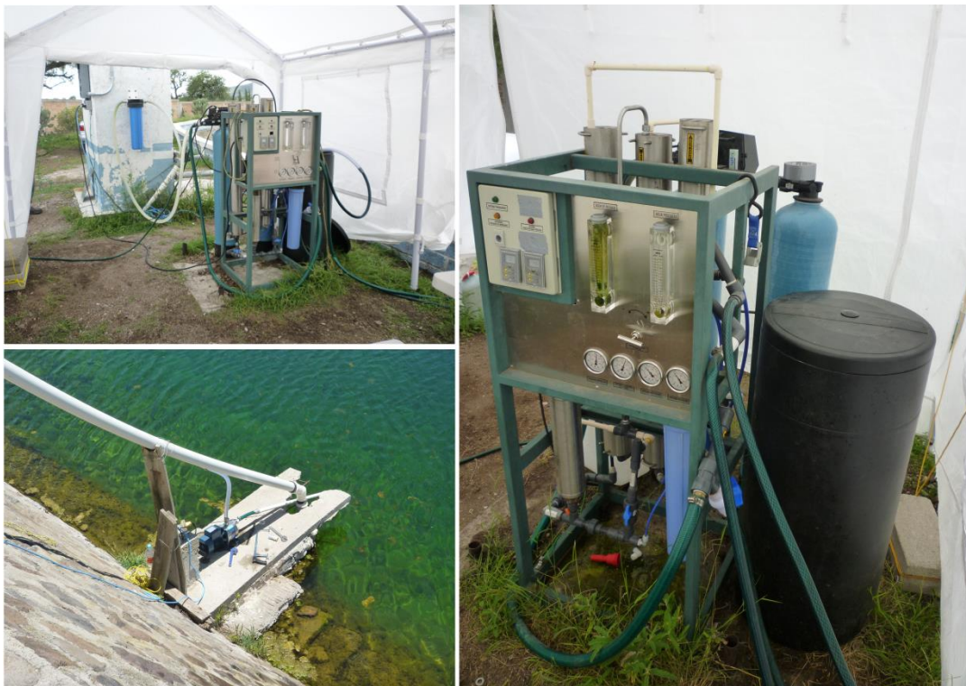
Figura 7. Planta piloto en operación. Abajo a la izquierda se observa la bomba que realizaba la toma de agua del manantial.
