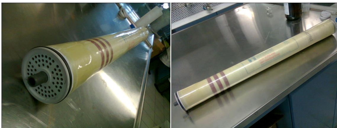
Figura 3. Membrana de nanofiltración Hidranautics ESPA3-4040 de dimensiones y morfología similares a la Dowtech NF270 utilizada en este estudio.
