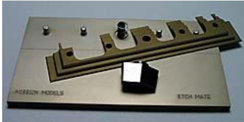
**Figura 13 Mecanismo con la cabeza de doblado desensamblada.**
