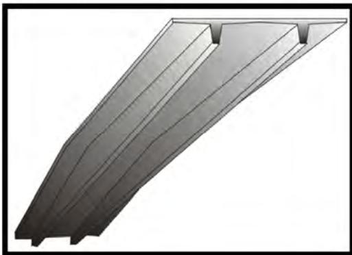
**Figura 18. Losa TT de peralte variable**
