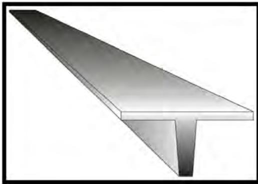
Figura 27. Losa nervadura T
