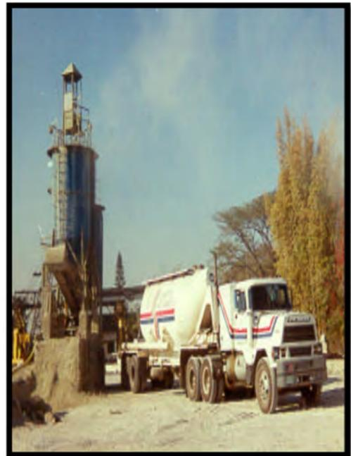
**Figura 57. Detalle de almacenaje y transporte de cemento a granel en una planta de producción**
