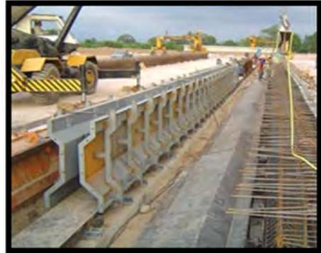
En plantas se presentan instalaciones fijas para tensado de torones con capacidad de 700 TON. de fuerza presforzante. Las trabes AASHTO pueden ser pretensadas, postensadas o combinadas. Son elementos estructurales de concreto presforzado; Ideales para soportar cargas para puentes en claros hasta de 30m.
