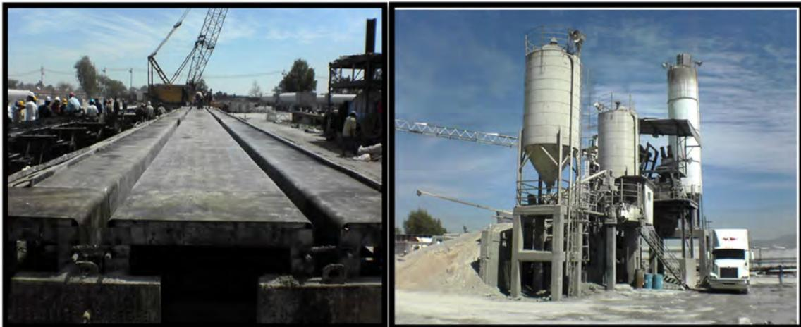
**Figura 61. Molde y mesa de colado presforzado para traveses doble T. y Fabricación de concreto en planta**
