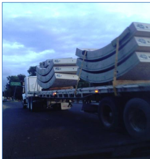
Imagen 3. 13 Transporte de dovelas
