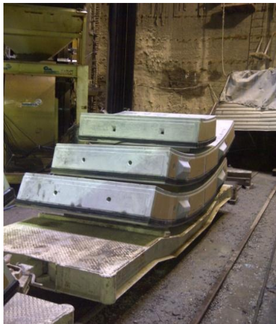
Imagen 3. 7 Revestimiento primario (Dovela)
