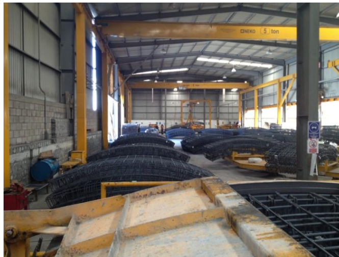
Imagen 3. 9 Fabricación de dovelas
