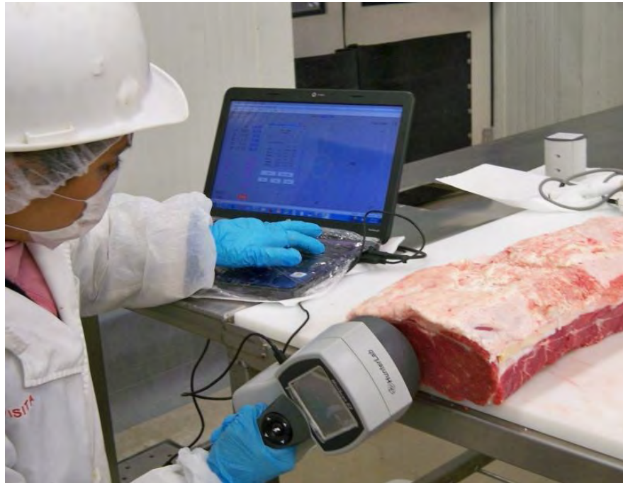
Figura 21. Toma de medidas objetivas con Hunter MiniScan EZ conectado al software OnColor de Konica Minolta
