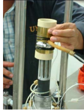
c) colocación de membrana
