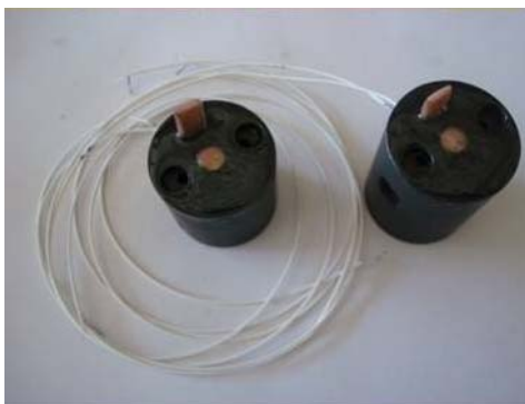
Figura 3.18 Cabezal y pedestal de Nylamid instrumentados con cristales piezoeléctricos
