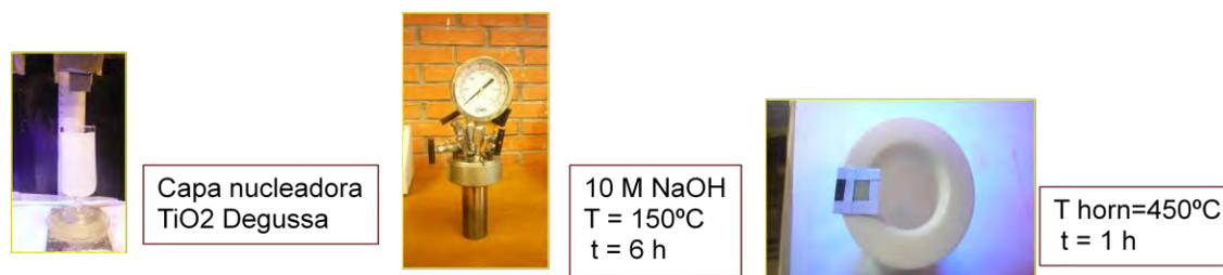
**Figura 2.2.** Procedimiento para obtención de películas  $\text{TiO}_2$  1-D por el método solvotérmico
