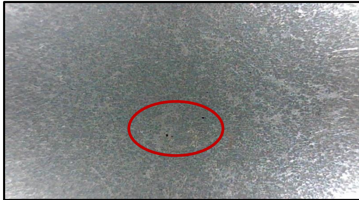
Figura 37.- Defectos internos en la pieza obtenida con cuatro inmersiones en pintura de zircón sin desgasificación (35X).
