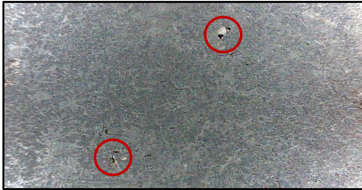
Figura 29.- Defectos internos en la pieza obtenida con dos inmersión en pintura de zircón, sin tratamiento de desgasificación (35X).
