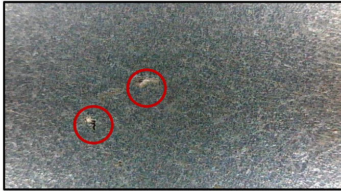
Figura 42.- Defectos internos en la pieza obtenida con una inmersión en pintura de grafito sin desgasificación (35X).
