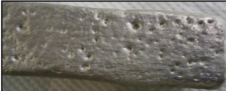
Figura 36.- Defectos superficiales obtenidos en piezas con cuatro inmersiones en pintura de zircón con desgasificación.
