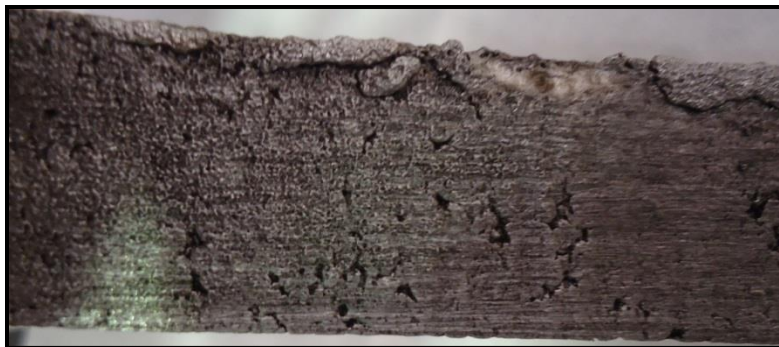
Figura 41.- Defectos superficiales obtenidos en piezas con una inmersión en pintura de grafito con desgasificación.
