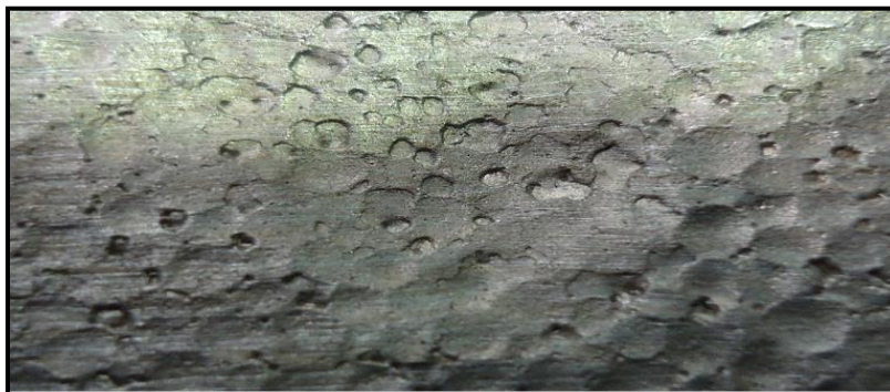
Figura 24.- Defecto superficial obtenido en pieza con una inmersión en pintura de zircón, con desgasificación.
