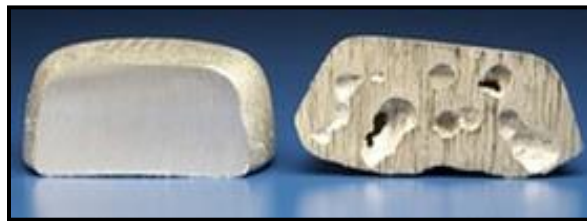
Figura 10.- Aleación con tratamiento de desgasificación (izquierda), Aleación de aluminio sin desgasificación (derecha).
