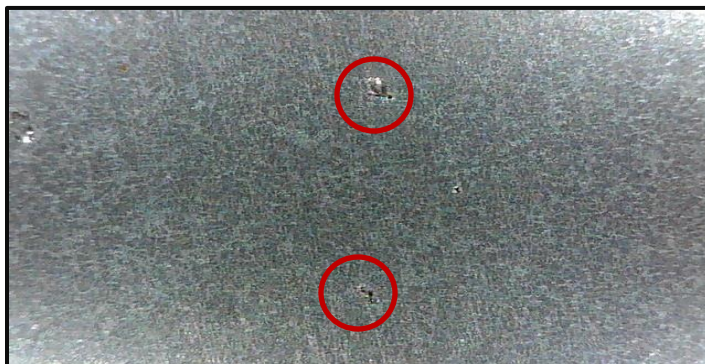
Figura 25.- Defectos internos en la pieza obtenida con una inmersión en pintura de zircón, sin desgasificación en la aleación (35X).
