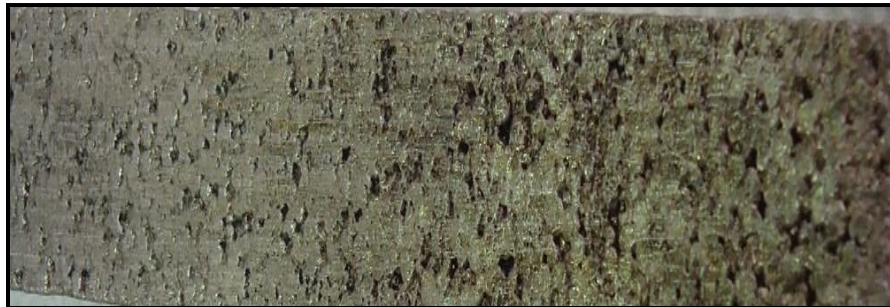
Figura 49.- Defectos superficiales obtenidos en piezas con seis inmersiones en pintura de grafito con desgasificación.
