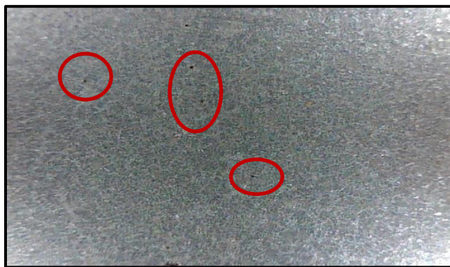
Figura 34.- Defectos internos en la pieza obtenida con tres inmersiones en pintura de zircón con desgasificación (35X).
