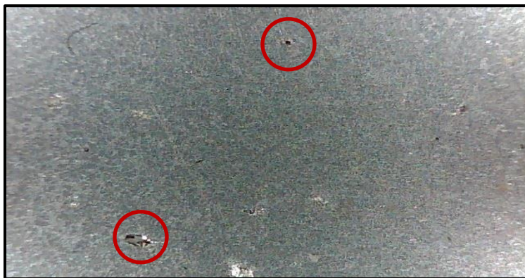
Figura 30.- Defectos internos en la pieza obtenida con dos inmersiones en pintura de zircón, con tratamiento de desgasificación (35X).
