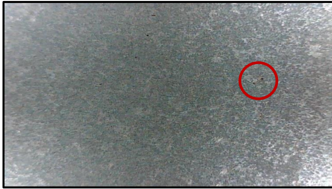
Figura 33.- Defectos internos en la pieza obtenida con tres inmersiones en pintura de zircón, sin desgasificación (35X).
