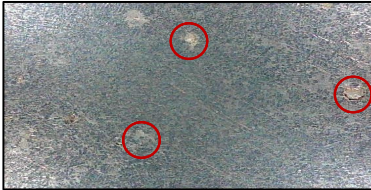
Figura 50.- Defectos internos en la pieza obtenida con seis inmersiones en pintura de grafito sin desgasificación.
