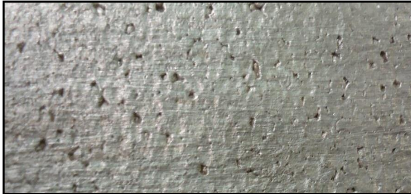
Figura 32.- Defectos superficiales obtenidos en piezas con tres inmersiones en pintura de zircón con desgasificación.
