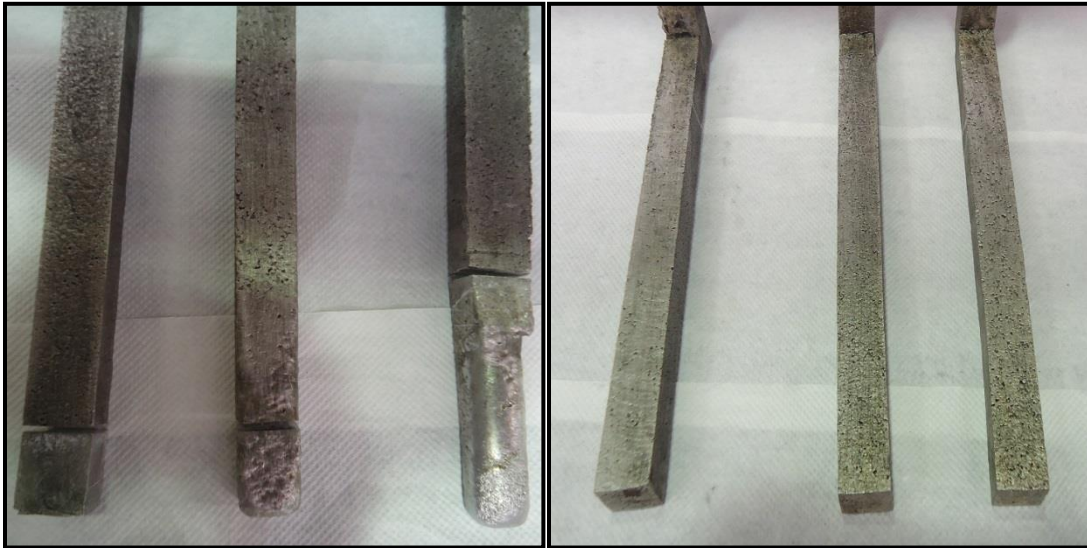
Figura 39.- piezas obtenidas con pintura de grafito sin tratamiento al metal líquido de desgasificación (izquierda) y con 8 min de desgasificación (derecha).
