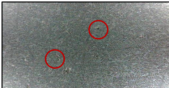
Figura 43.- Defectos internos en la pieza obtenida con una inmersión en pintura de grafito con desgasificación (35X).
