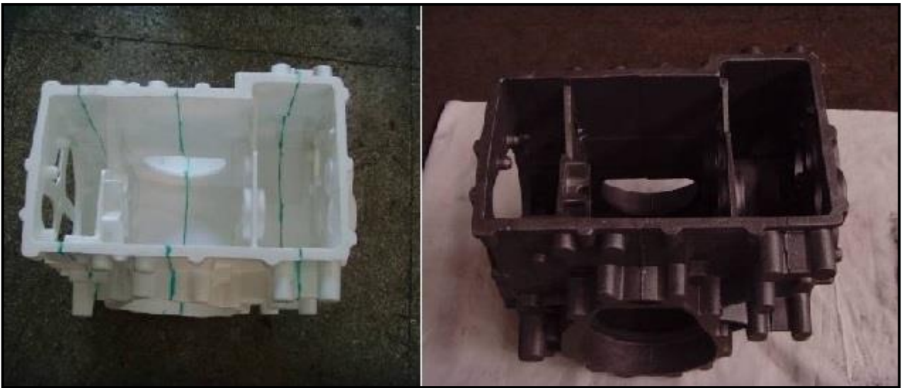
Figura1.- Molde de EPS (izquierda), Pieza final obtenida a partir del molde anterior (derecha).
