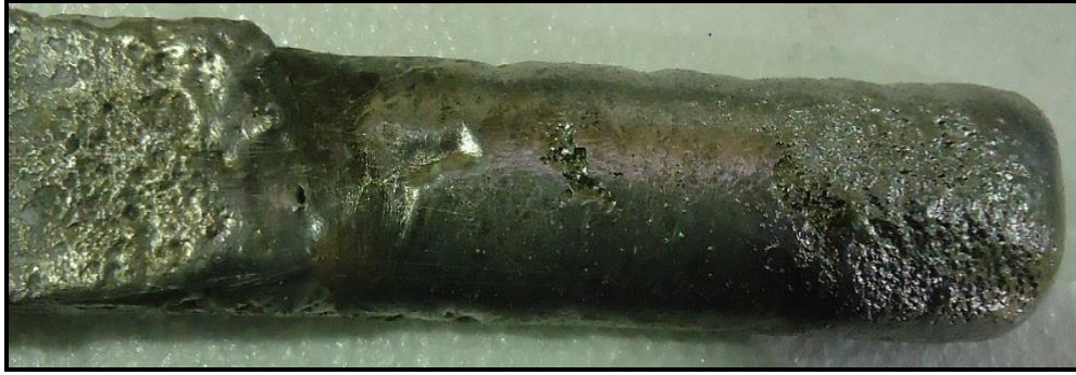
Figura 48.- Defectos superficiales obtenidos en piezas con seis inmersiones en pintura de grafito sin desgasificación.
