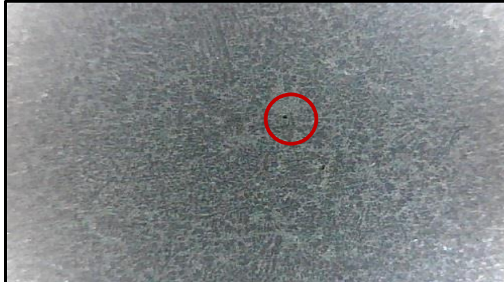
Figura 51.- Defectos internos en la pieza obtenida con seis inmersiones en pintura de grafito con desgasificación.
