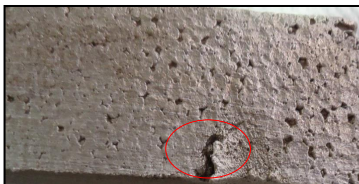
Figura 28.- Defectos superficiales obtenidos en piezas con dos inmersiones en pintura de zircón, con desgasificación.
