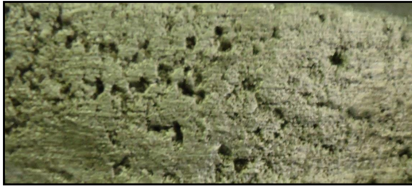
Figura 44.- Defectos superficiales obtenidos en piezas con cinco inmersiones en pintura de grafito sin desgasificación.
