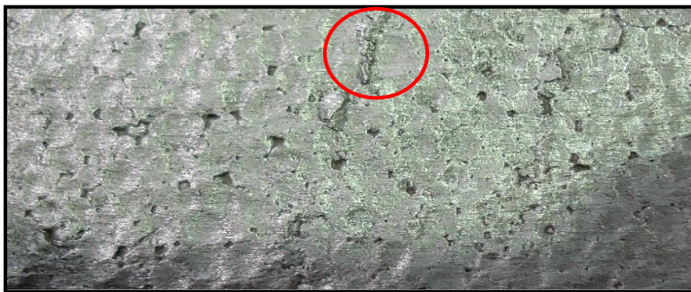
Figura 22.- Defectos superficiales (poros) obtenidos en piezas con una inmersión en pintura de zircón, sin tratamiento de desgasificación.
