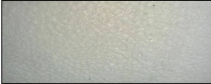
Figura 19.- textura del EPS utilizado para la fabricación de los moldes.
