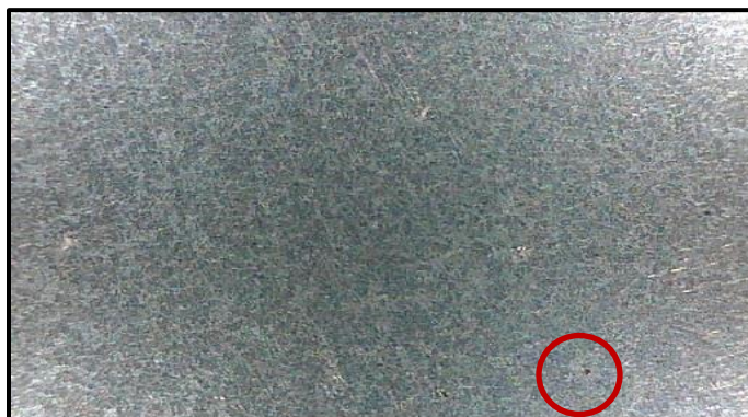
Figura 26.- Defectos internos en la pieza obtenida con una inmersión en pintura de zircón, con desgasificación en la aleación (35X).
