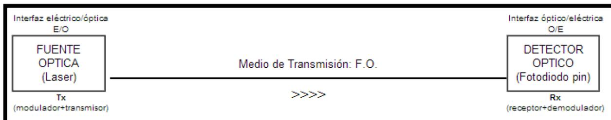
**Fig. 1.20.** Trasmisión con fibra óptica, (FO).
