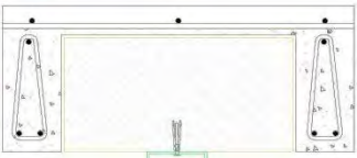
sección de losa con la colocación de la abrazadera
