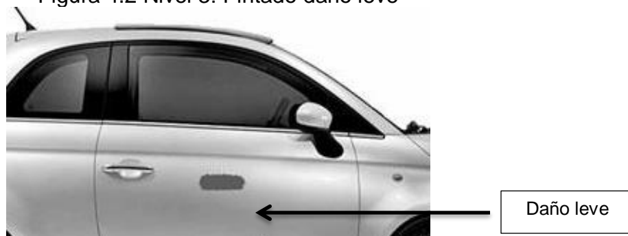
Figura 4.2 Nivel 3: Pintado daño leve
