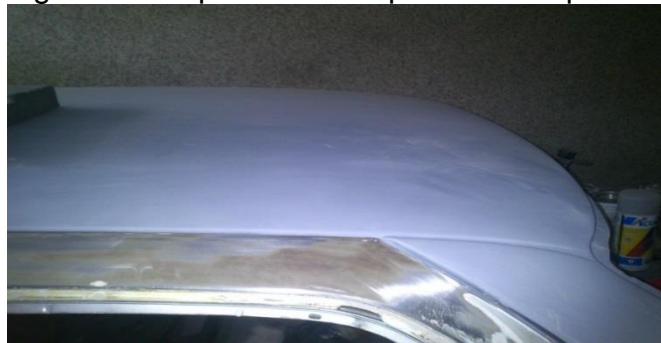
Figura 4.8 Superficie con aplicación de primario
