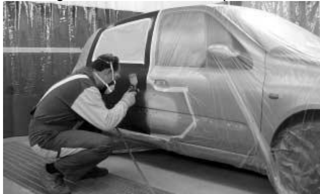
Figura 4.7 Proceso de imprimación
