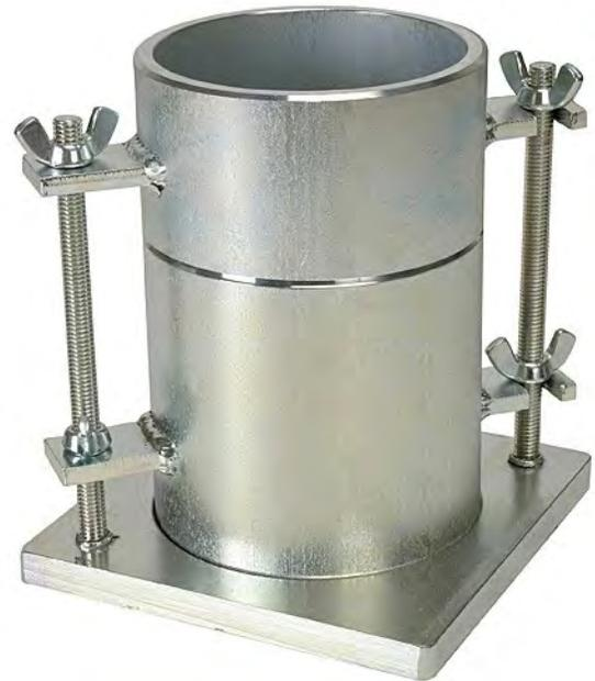
*Fig 1.7. Molde para ensayo de compactación Proctor.*
