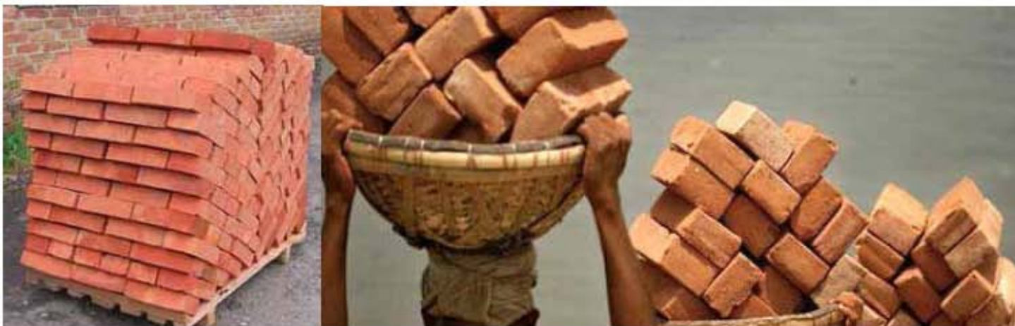
Ejemplos de casos en donde el ladrillo funciona como cuña cuando se lo almacena o transporta.
