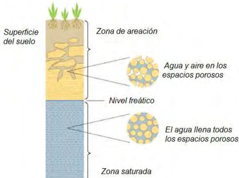
Fig.2.1 Distribución del subsuelo (modificado de [www. geociencias. unam. mx/~rmolina/ geologia%20fisica/ aguas1. html](http://www.geociencias.unam.mx/~rmolina/geologia%20fisica/aguas1.html))
