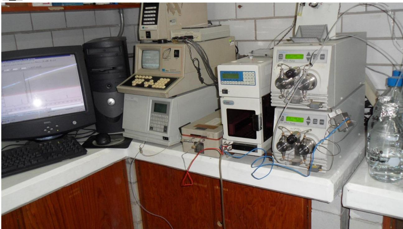
Figura 12. Cromatógrafo de líquidos de alta eficiencia.
