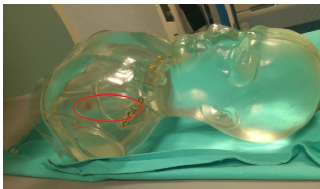
Fig 5.10 Maniquí antropomórfico, con el contenedor con actividad diluida dentro.
