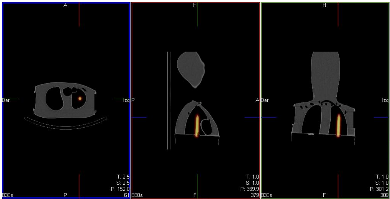
Fig 5.11 Reconstrucción de SPECT-CT con fuente dentro del maniquí antropomórfico
