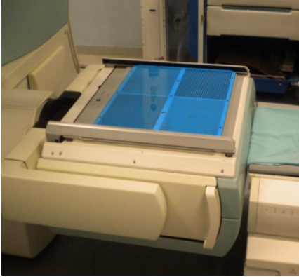
Fig 5.4 Maniquí con barras de plomo colocado sobre el detector.
