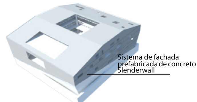
Colocación de fachada prefabricada
