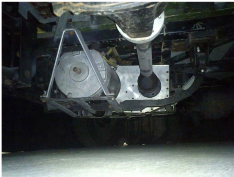
Figura 2.9 Reductor montado en el vehículo.
