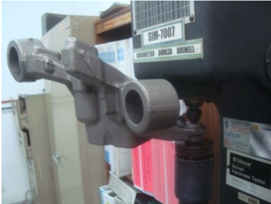
Imagen III.5 Colocación de la pieza en la base del
