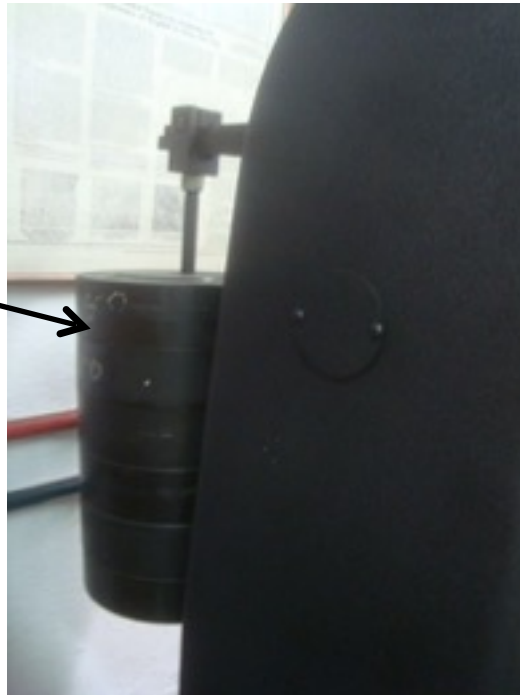
Imagen III.4 Cargas de 500 Kg para pruebas de dureza.
