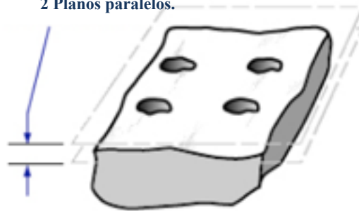
Fig. IV.9 La zona de tolerancia de la planitud es delimitada por dos planos paralelos entre sí.
