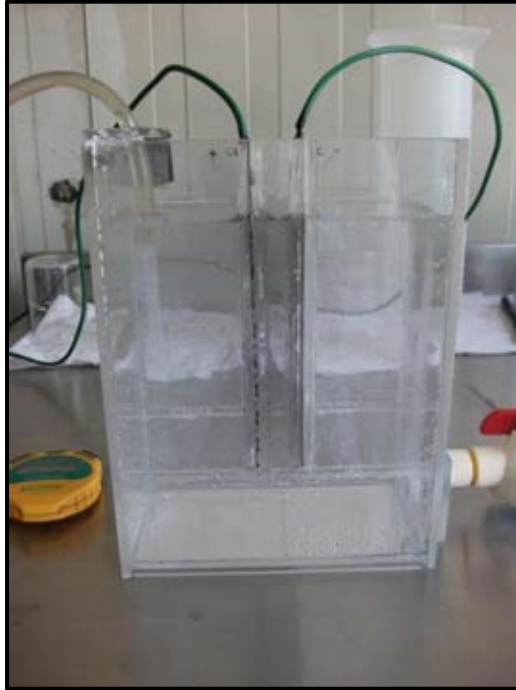
Imagen 3.1 Vista frontal del reactor electroquímico.
