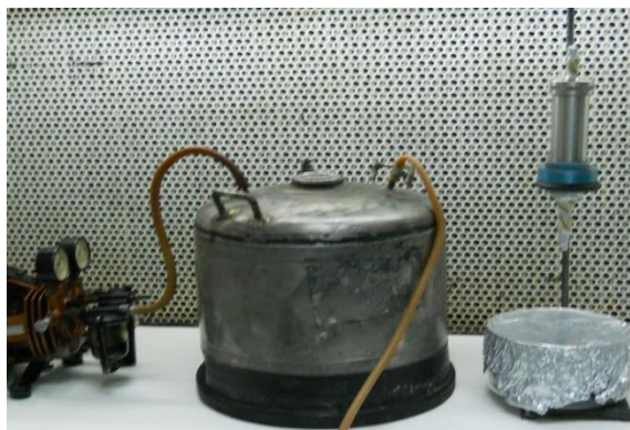
Imagen 14. Procedimiento para esterilizar el extracto por medio de un filtro de bala y una bomba de vacío.
